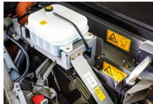
Der Ausgleichsbehälter verhindert, dass Motorteile überhitzen.
