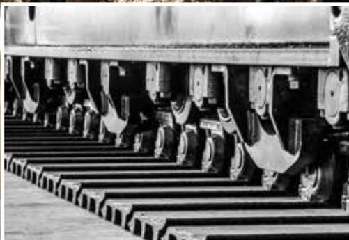
Mehr Laufrollenschutz-Einheiten erhöhen die Langlebigkeit der Kettenglieder.
