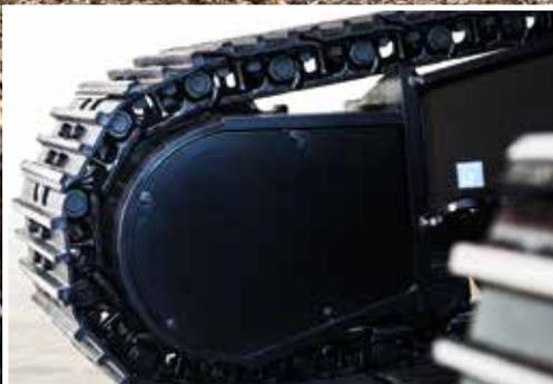
Die dickere Fahrmotorabdeckung bietet mehr Schutz vor Schäden.
