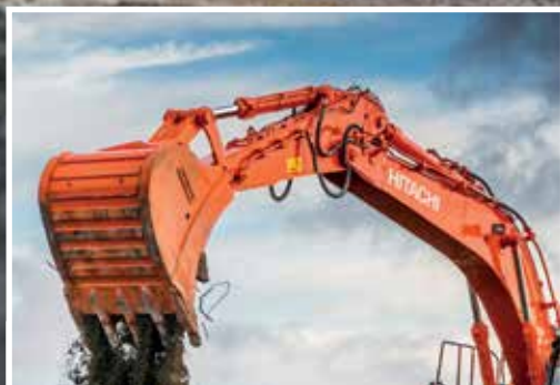
Verstevigde boom- en armverbindingen
