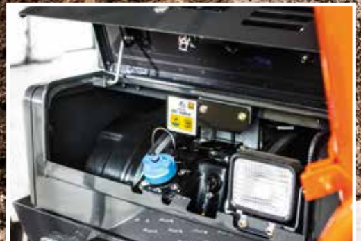
Mocznik jest wstrzykiwany do gazu wylotowego w celu zredukowania emisji.
