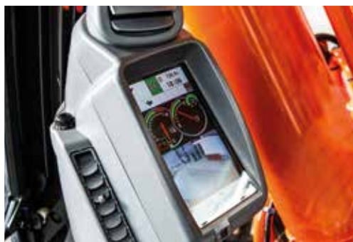
Monitor LCD przedstawia stan i ustawienia maszyny.
