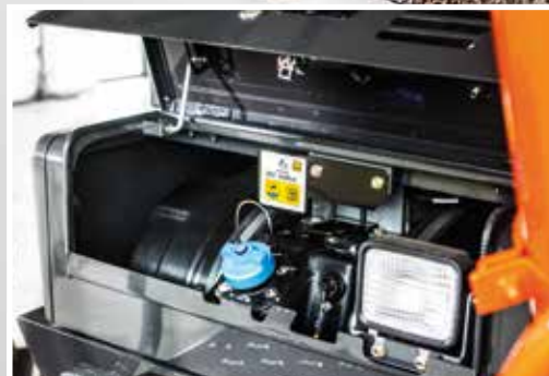
AdBlue® jest wstrzykiwany do gazu wylotowego w celu zredukowania emisji.
