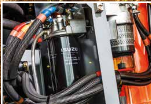
Łatwiejsza wymiana głównego filtra paliwa.
