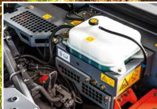
Zbiornik wyrównawczy zapobiega przegrzewaniu się części silnika.
