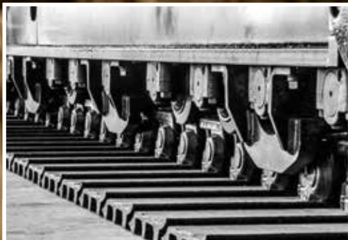
Większa liczba osłon gąsienicy podnosi trwałość ogniw gąsienicy.
