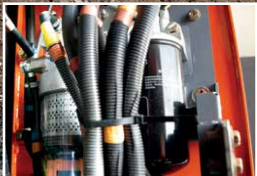
Il filtro principale del carburante è facilmente sostituibile.
