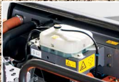
De expansietank voorkomt oververhitting van motoronderdelen.
