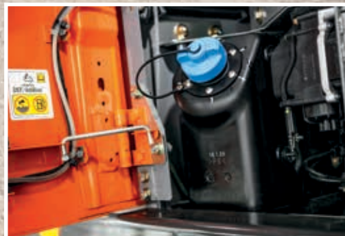
Vstřikování močoviny do výfukových plynů snižuje emise.
