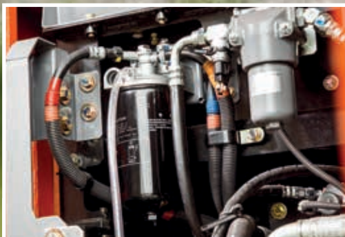
Hlavní palivový filtr lze snáze vyměnit.
