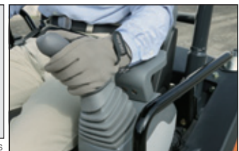
Levier de lame avec commutateur de translation à deux vitesses
