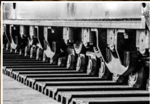
La incorporación de más protectores de cadena mejora la durabilidad de la articulación de la oruga.
