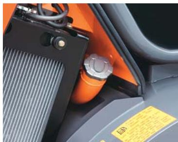
al minimo i tempi impiegati per il rifornimento durante l'orario lavorativo, aumentando di conseguenza la produttività. Il serbatoio del liquido lavavetri, è facilmente raggiungibile dall'operatore ed è localizzato sotto i gradini. Anche la posizione del motorino tergicristalli della pala gommata compatta è stata attentamente studiata in modo da non ostruire il campo visivo durante il suo funzionamento.
