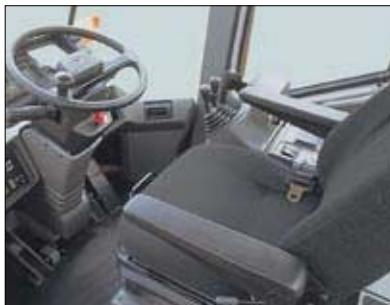
Сиденье установлено на подвеске и имеет все необходимые регулировки, что позволяет снизить утомляемость оператора и повысить производительность его работы.
