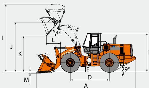
Для погрузчика со скальным ковшом вместимостью 6,1 м<sup>3</sup> с V-образной режущей кромкой, бескамерными шинами 35/65-33-24 (L4) и кабиной без встроенных защитных конструкций
