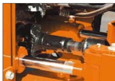
Герметичные уплотнения карданных шарниров увеличивают интервалы смазывания до 12 000 часов, упрощая техническое обслуживание и увеличивая ресурс шарниров.
