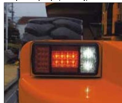
Задние габаритные фонари оснащены долговечными светодиодными лампами, которые имеют высокую яркость свечения и большой срок службы.
