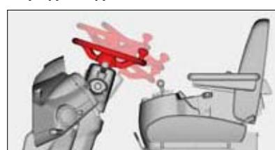
Рулевая колонка позволяет регулировать угол наклона и вылет рулевого колеса в соответствии с комплекцией оператора, повышая удобство его работы.
