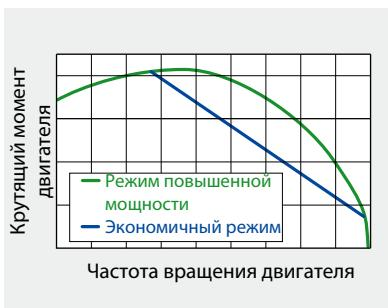
Двигатель имеет два режима работы: режим повышенной мощности и экономичный режим. Режим повышенной мощности позволяет повысить производительность машины, в то время как экономичный режим обеспечивает снижение расхода топлива.
