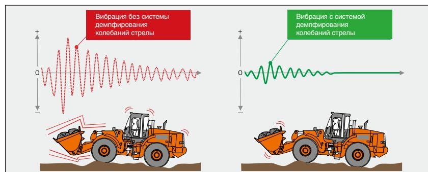
Система демпфирования колебаний стрелы уменьшает раскачивание погрузчика при движении по неровной или заснеженной дороге. Эта система в автоматическом режиме управляет рабочим оборудованием погрузчика, уменьшая ударные нагрузки и вибрации.
