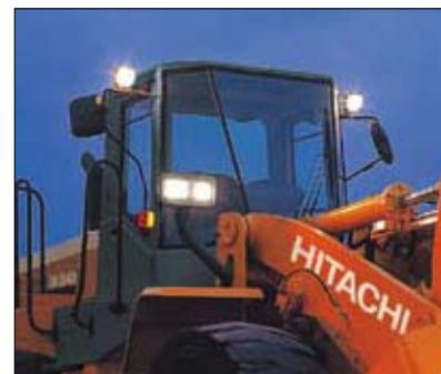
Передние и задние фонари рабочего освещения оснащены галогеновыми лампами высокой яркости, повышающими безопасность работ в темное время суток.
