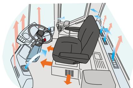
Кондиционер-отопитель, имеющий полностью автоматическую систему управления с функцией поддержания заданной температуры, повышает уровень комфорта на рабочем месте оператора. Воздушные дефлекторы эффективно создают циркуляцию воздуха в кабине и защищают стекла от запотевания в любую погоду. Для защиты от загрязнений в кабине поддерживается избыточное давление.
