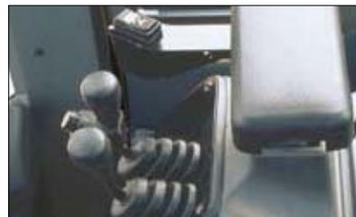
Переключатель направления движения, установленный рядом с рычагами управления, позволяет легко изменять направление движения. При этом оператору не приходится снимать левую руку с рулевого колеса.
