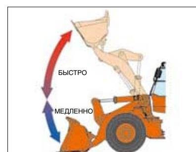
Эффективная система погрузки (ELS) повышает тяговое усилие при наполнении ковша и одновременно снижает расход топлива. Это позволяет повысить производительность и топливную экономичность погрузчика.
