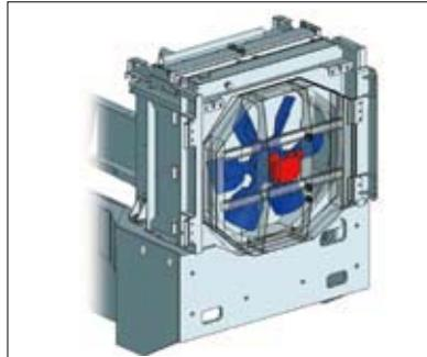
Гидравлический привод изменяет частоту вращения вентилятора в зависимости от рабочих температур, уменьшая уровень шума и расход топлива. Вентилятор имеет функцию автоматического реверса с возможностью ручного управления. Откидное крепление вентилятора позволяет легко очищать радиаторы от загрязнений.
