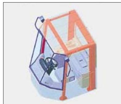
Кабина оснащена конструкциями ROPS/FOPS, защищающими оператора от травм в аварийных ситуациях.
