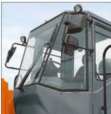
Внутренние и наружные зеркала заднего вида обеспечивают хороший обзор пространства вокруг машины. Переднее окно оснащено плоским стеклом, которое крепится при помощи резиновых уплотнений и может быть легко заменено. Кабина установлена на вязкостных амортизирующих опорах, которые поглощают удары и понижают уровень шума, создавая комфортные условия работы оператора.
