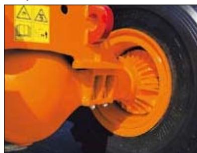
Маслопогруженные дисковые тормоза, установленные в герметичных корпусах на ступицах колес, развивают большое тормозное усилие и не подвержены воздействию загрязнений. Независимые двойные тормозные магистрали переднего и заднего мостов дополнительно повышают уровень безопасности.
