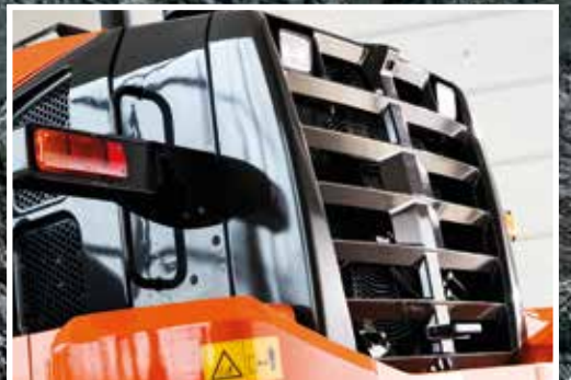
Opcjonalne niezapychające się chłodnice zwiększają wytrzymałość.
