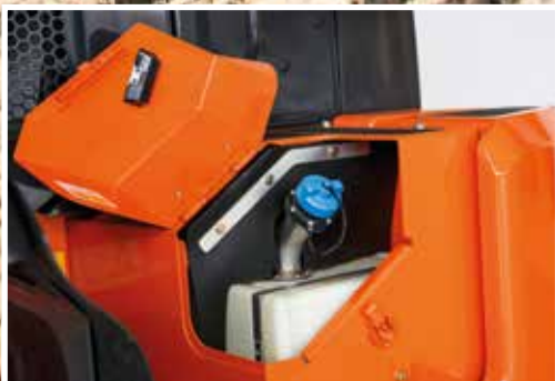
Ad-Blue jest wstrzykiwany do gazów spalinowych w celu zredukowania emisji.
