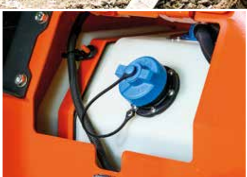
Il serbatoio dell'urea è posizionato in modo da consentire un accesso facile e sicuro dal suolo.
