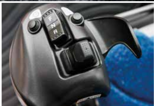
Le système de direction à manette en option offre un maniement exceptionnel.
