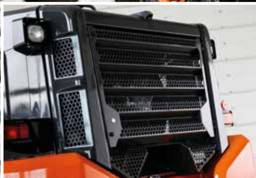
Une nouvelle grille arrière protège le compartiment du radiateur.
