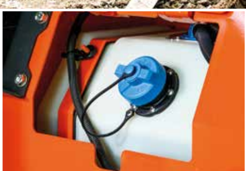
Le réservoir d'urée est situé dans un endroit sûr et facilement accessible depuis le sol.
