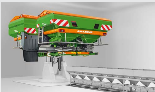
Hall de test moderne pour épandeurs d'engrais
