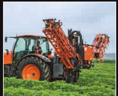
Das HC Gestänge ist ein Multi-Talent. Die Dreiecks-Stahlkonstruktion und das einzigartige Dämpfungssystem erlauben auch in schwierigen Bedingungen hohe Arbeitsgeschwindigkeiten.
