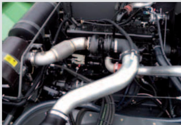
Facilité d'accès au moteur AGCO SISU POWER 7 cylindres
