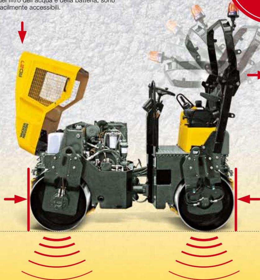
Sull'RD 27 la roll bar ribaltabile (ROPS\*) fornita di serie può essere ribaltata sia in avanti che all'indietro. Ciò permette una maggiore versatilità di impiego, ad esempio sotto alle tettoie, e semplifica il trasporto. Sull'RD 16 la roll bar può essere ribaltata solo in avanti.
