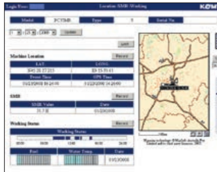
Horómetro – Con el gráfico “registro trabajo diario”, reciba información precisa sobre el tiempo de funcionamiento: cuando se arrancó su máquina y cuando se apagó, junto con el tiempo de funcionamiento del motor.
