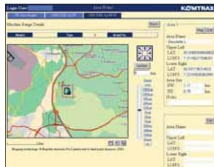
*Sicurezza ulteriore – La caratteristica “Blocco motore” permette di programmare quando il motore di una macchina può essere acceso. In più con “geo-fence” Komtrax ti invia un messaggio di notifica ogni volta la tua macchina entra od esce da una area operativa predeterminata.*
