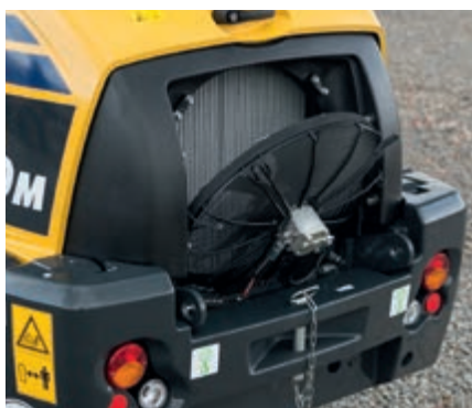
Uchylny wentylator dla wygodnego czyszczenia chłodnicy
