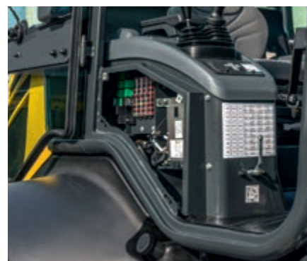
Boczna pokrywa ułatwia dostęp do bezpieczników
