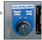
puissant ou normal. En mode chargement puissant, le débit vers l'équipement de travail peut être ajusté lorsque cela s'avère nécessaire. En mode chargement normal, tout le débit hydraulique est transféré directement vers l'équipement de travail.
