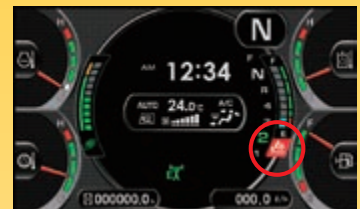
AdBlue®-Füllstandanzeige und Nachfüllhinweis
