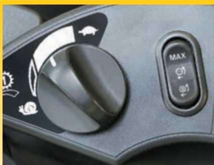
Pokrętło sterowania zmianą przełożenia wraz z zakresem prędkości pełzającej (po lewej) i włącznik systemu sterowania zmianą trakcji (po prawej)
