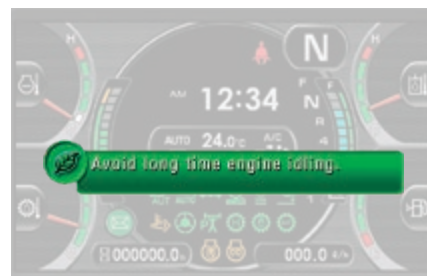
Wskaźniki ekologiczne zapewniają utrzymanie oszczędności energii na bieżąco (np. zapobieganie długotrwałej pracy silnika na biegu jałowym)
