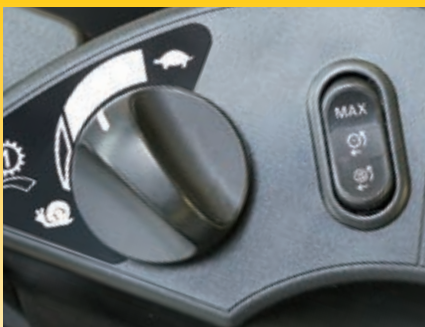
Otočný ovladač rychlosti s rozsahem mikropojezdu (vlevo) a spínač změny účinku systému traction control (vpravo)
