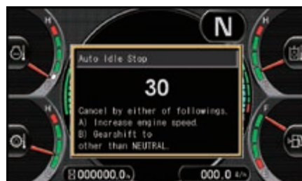
Možnost nastavení doby pro vypnutí motoru vypne motor, pokud běží po nastavenou dobu ve volnoběžných otáčkách
