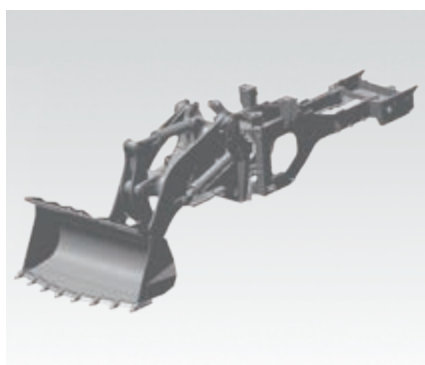
Châssis robuste et résistant à la torsion
