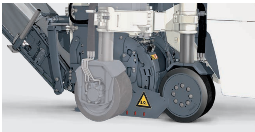
Rientro rapido della ruota posteriore destra.
