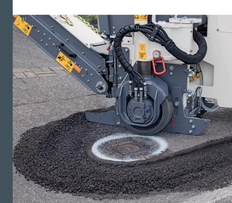
1-2 Der elektronisch geregelte Fahrantrieb ermöglicht exaktes Fräsen - wie z. B. an Straßeneinbauten.
