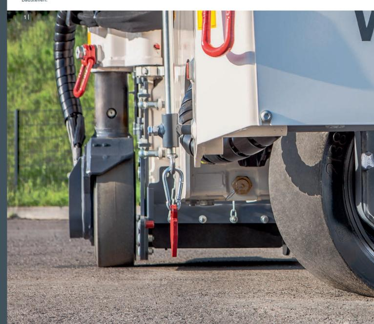
2 Schnelles Rangieren in engen Passagen beherrscht die Kleinfräse ausgezeichnet - auch dank einfachem Einschwenken des rechten Hinterrads.
