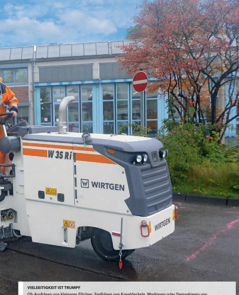
Ob Ausfräsen von kleineren Flächen. Freifräsen von Kanaldeckeln. Markieren oder Demarkieren von Fahrbahnmarkierungen. Nacharbeiten als Partnermaschine von Großfräsen. Ausgestattet mit unterschiedlichsten Fräswalzen. Und mit der innovativen WIRTGEN Schneidtechnologie. Die vielseitige Kleinfräse W 35 Ri hat auf fast alles die passende Antwort.
