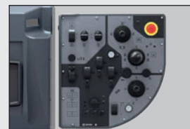
Панель управления, на площадке машиниста, с правой стороны
