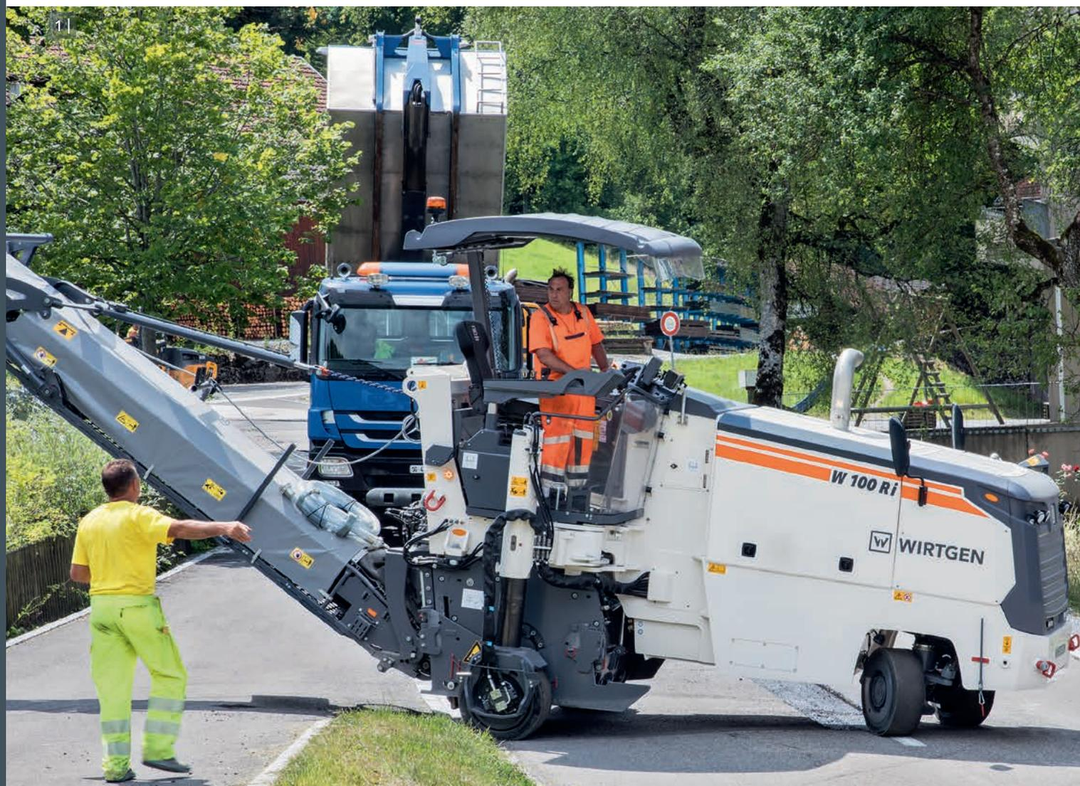
2 | Das eingeschwenkte rechte Hinterrad erlaubt präzises Fräsen entlang von Hindernissen wie Bordsteinkanten oder Mauern.
