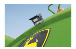
Las cámaras opcionales ayudan a controlar la parte trasera de la cosechadora al desplazarse en marcha atrás o a comprobar la distribución de los residuos. En el sinfín de descarga ayudan a ver el interior del remolque y en el enganche facilitan el acoplamiento del remolque del cabezal. Un monitor adicional se instala en la cabina para mostrar las imágenes de la cámara.
