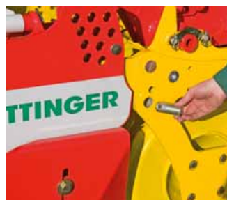
Togliere il perno di fissaggio del rullo di trascinamento – guida a forma di parallelogramma
