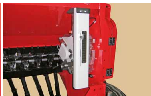
Regolazione elettrica della quantità della semente
