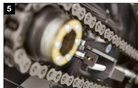
Solidne i szerokie szczotki olejowe na łańcuchach: doskonale smarowanie
