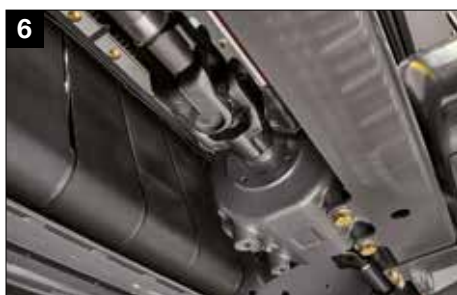
6 Wzmocnione krzyżaki wałów napędowych
