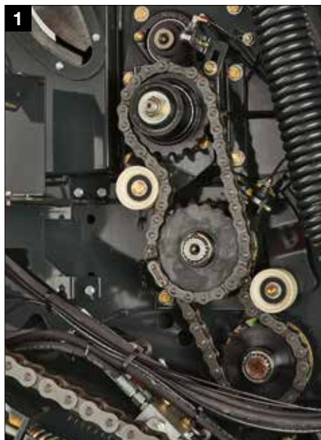
Druga rolka napędowa: gwarantuje prawidłowe prowadzenie pasa w każdych warunkach roboczych.
