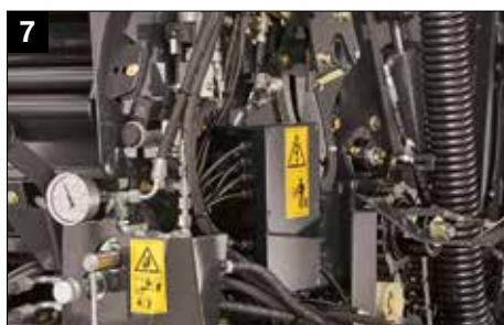
7 Zawór proporcjonalny regulujący zgniot beli z poziomu kabiny
