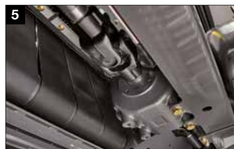
5 Wzmocnione krzyżaki wałów napędowych
