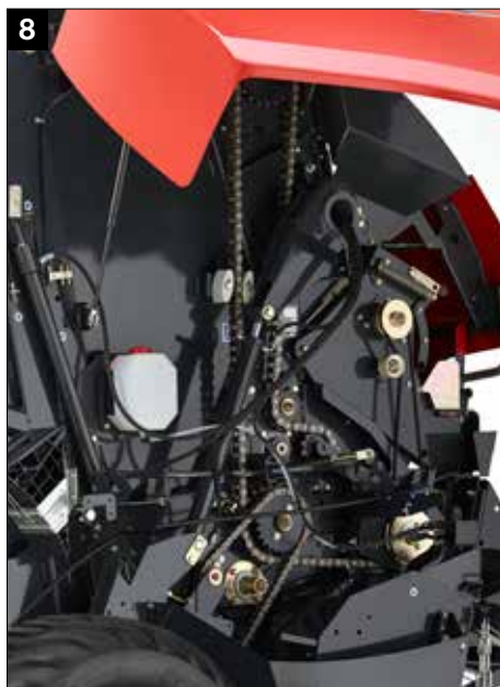
8 Wzmocniony układ napędowy z wytrzymałymi łańcuchami IWIS + wzmocniony główny napęd 1¼» 20BH z chromowanymi utwardzonymi sworzniami
