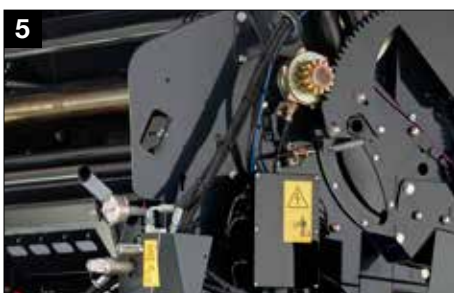
Zawór proporcjonalny regulujący zgniot bel z poziomu kabiny
