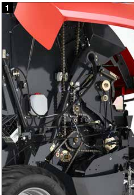
1 Wzmocniony układ napędowy z wytrzymałymi łańcuchami IWIS
