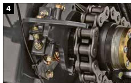
Débrayage mécanique du rotor
