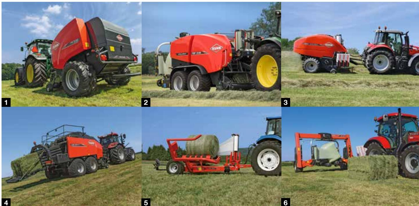
1. Presses à chambre fixe - 2. Combinés presses-enrubanneuses BalePack - 3. i-BIO+ - 4. Presses haute densité - 5. + 6. Enrubanneuses pour balles rondes et rectangulaires.
