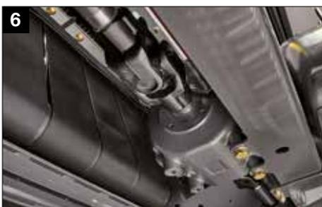
Arbres d'entraînement avec joints de cardan intégrés
