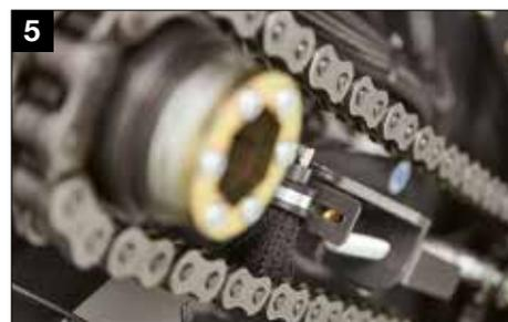
Brosses de lubrification larges et solides sur les chaînes, pour une lubrification optimale
