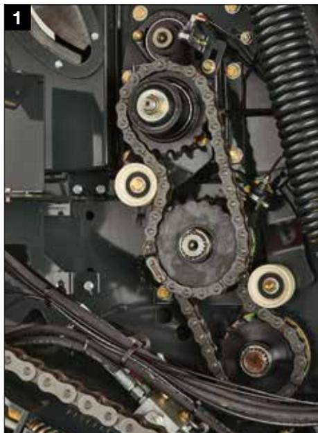
Le deuxième rouleau entraîné par courroie assure un entraînement de courroie sûr quel que soit le fourrage
