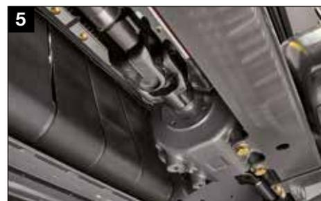
Arbres d'entraînement avec joints de cardan intégrés
