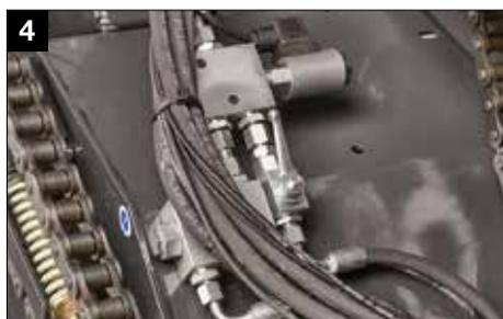
Contrôle de couteau / trappe escamotable DROPFLOOR séparé, actionné depuis le siège du tracteur
