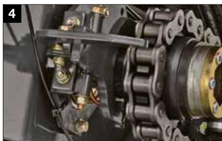
Débrayage mécanique du rotor
