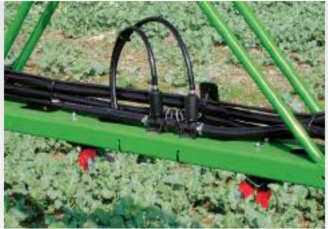
Sistema de circulación forzada SCF
