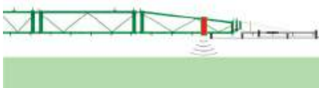
DistanceControl para equipamiento con dos sensores: medición en el cultivo
