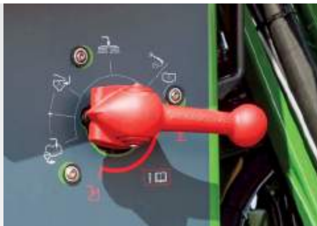
✔ Manejo sencillo mediante la llave de presión de 7 vías
