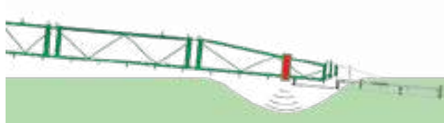
DistanceControl para equipamiento con dos sensores: Las barras pueden sumergirse en el cultivo, por ejemplo, en el caso de acumulaciones de grano
