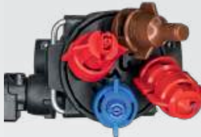
Cuerpo de boquilla cuádruple AmaSwitch
