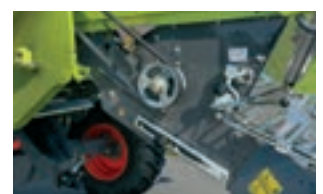
Elektrohydraulische Zuschaltung des Strohhäckslers
