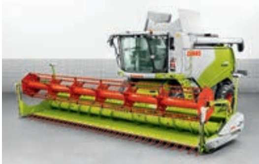
VARIO Schneidwerk mit Rapsausrüstung
