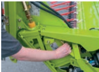
Werkzeuglose Verriegelung der Halmteiler und Rapstrennmesser
