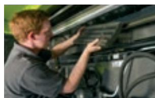
Wechseln der MULTICROP Vorkörbe
