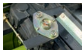
Unter jeder Pflückerinheit zerkleinert ein horizontal drehendes Messer den Stängel in schnell verrottende kleine Stücke.
