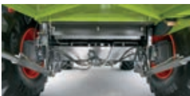
2-Wege-Schneidwerkszylinder regeln präzise den Auflagedruck.
