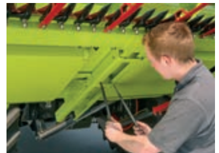
Verstellung der Tischlänge beim CERIO 930 und 770
