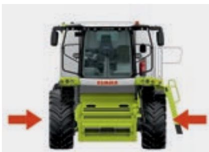
Verringerte Transportbreite bei vergrößerter Aufstandsfläche
