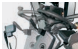
Die Lenksäule ist 3-fach verstellbar.
