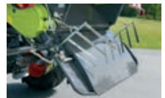
Schwadformer auf dem Streublechverteiler
