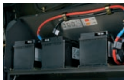
Drei Batterien für den TUCANO: Zwei sind für die 24-V-Motorelektro- nik in Reihe geschaltet, eine versorgt die 12-V-Bordelektronik.
