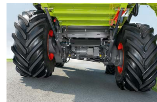
Assale anteriore MONTANA con sterzata massima
