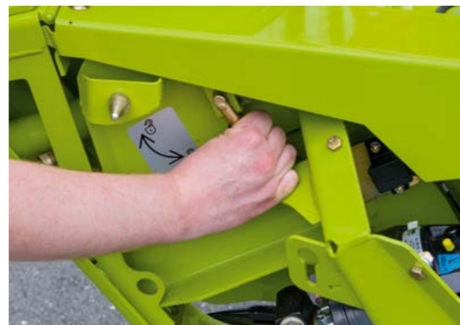
Bloccaggio senza attrezzi degli sparticampo e delle lame di taglio per colza con il sistema di attacco rapido
