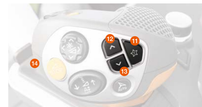
Leva CMOTION: selezione dei Preferiti (11), selezione Preferiti in avanti (12), indietro (13), impostazione dei valori tramite pulsante (14)
