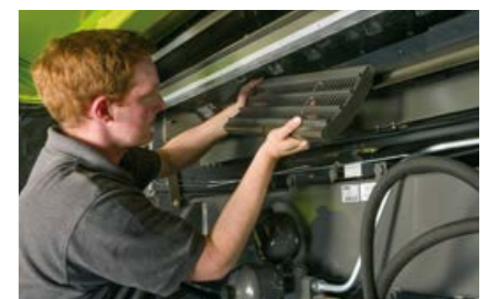
Sostituzione delle griglie di preseparazione MULTICROP
