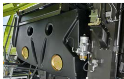
Serbatoio carburante con capacità fino a 750 l
