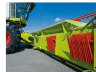
Alzaspighe di ricambio direttamente sul retro della piattaforma di taglio
