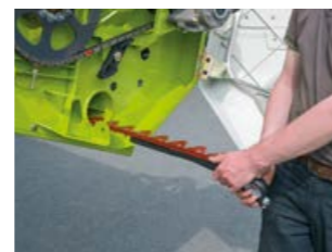
Lama di taglio di ricambio integrata nella parte inferiore della piattaforma di taglio
