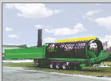
Le TS 7020 est un crible à tambour rotatif pour le calibrage efficace des déchets ménagers, résidus de parcs et jardins et pour le tri et nettoyage des scories et gravats. Le calibrage est réalisé en deux ou trois fractions dont la composition est déterminée par le choix du tambour. Pour des matériaux lourds tels que scories et gravats, des rouleaux porteurs supplémentaires dans la trémie de remplissage sont recommandés.
