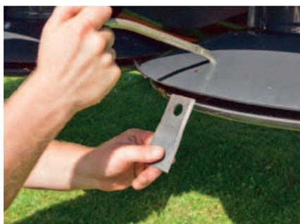
Klingenschnellwechsel – Werkzeug herunterdrücken und die Klappen wechseln.
