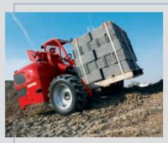
Zusätzlich zum 50 PS Perkins Motor verfügt der TMT 2502 SR XT über einen optimalen Antrieb: um 25 % verbesserte Zugkraft im Vergleich zu den anderen Modellen (2780 daN).
