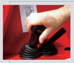
Durch das neue, im Hebel integrierte Konzept für die Fahrtrichtungsumkehr kann der Fahrer immer eine Hand am Lenkrad und eine Hand am Hebel lassen. So profitieren Sie von einer Zeitersparnis und genießen maximalen Fahrkomfort.
