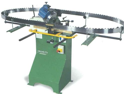
Schärfmaschine für 50 – 130 mm breite und 0,8 – 1,3 mm dicke Sägebänder bis 8000 m Länge mit Elektroantrieb für alle Zahnformen
