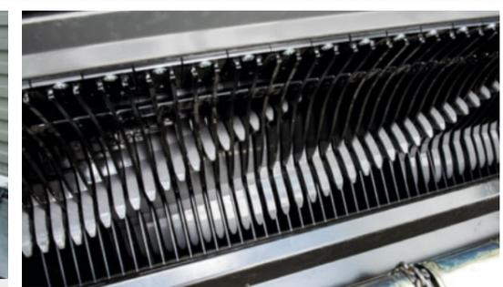
El rotor de 800 mm de diámetro y siete filas de dientes en espiral de acero Hardox está equipado en ambos lados con grandes rodamientos oscilantes de rodillos.
