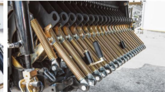
El bastidor de corte abierto reduce los trabajos de mantenimiento y limpieza, ya que la geometría abierta del bastidor permite que lo atraviese todo tipo de suciedad hasta llegar al suelo. El sistema de liberación central de las cuchillas le permite cambiar con rapidez y facilidad cuchillas individuales.
