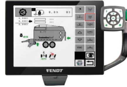
Controle la mampara y el bastidor de corte directamente a través del terminal. Desde aquí también puede ajustar de forma cómoda el pick-up y la barra de tiro de enganche.
