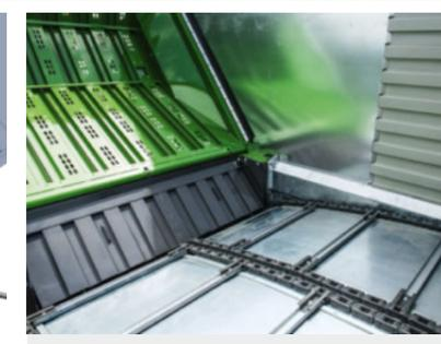
Para proteger el rotor frente a la corrosión y la contaminación cuando se utiliza en la recolección de maíz, el Fendt Tigo cuenta con una cubierta de canal de maíz que puede colocarse rápidamente y sin necesidad de herramientas.
