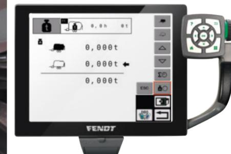
El sistema de pesaje integrado de forma opcional en la suspensión hidro-neumática del chasis le muestra el rendimiento del cultivo cómodamente en su cabina. Esto le permite mantener un control constante del peso y la carga útil.
