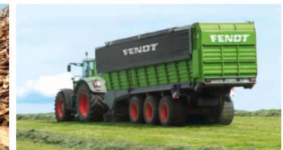
La cubierta hidráulica del espacio de carga se maneja fácilmente a través del terminal.
