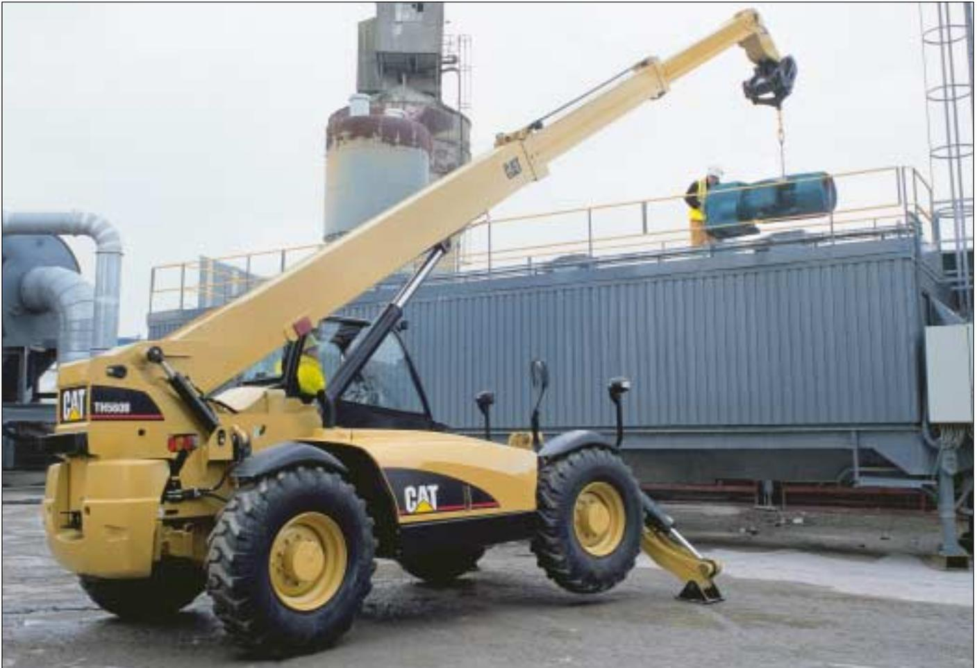
**Высота подъема груза.** Погрузчик ТН560В способен быстро и эффективно поднять кирпич, кровельные материалы и фермы на высоту до 13,5 м.
