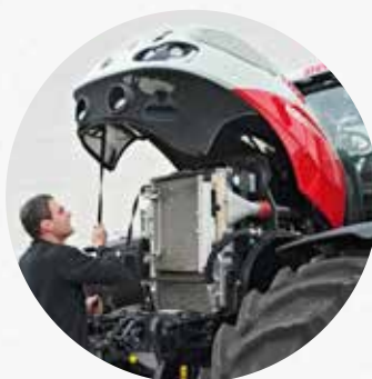
Jednoczęściowa maska silnika ze sprężyną gazową może być unoszona w dwóch pozycjach (45°/90°), nawet z dobudowanym urządzeniem czołowym.
