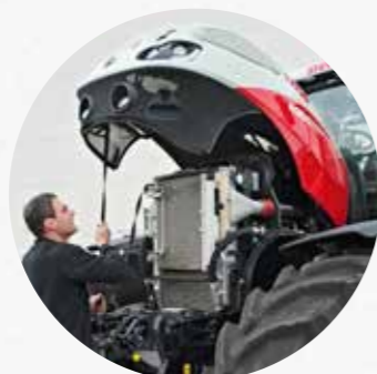
Il cofano monostruttura assistito da ammortizzatori a gas è facilmente ribaltabile in due posizioni (45°/90°), anche con attrezzi anteriori accoppiati.
