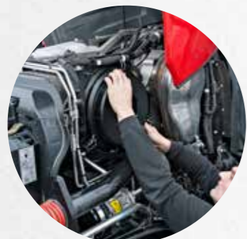
Grazie alla pulizia continua attraverso un filtro Piclon, la manutenzione del filtro dell'aria è necessaria solo quando si accende l'apposita spia luminosa.
