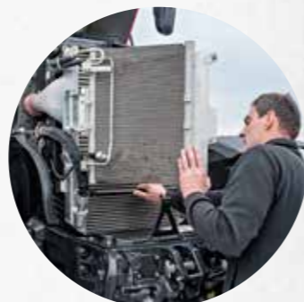
La pulizia del radiatore e dell'impianto del condizionatore dell'aria è rapida e agevole.
