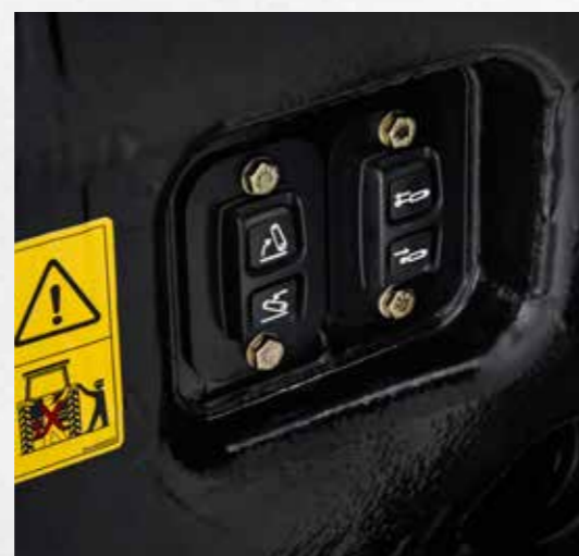
Facile accessibilità: comando esterno per sollevatore anteriore, PTO anteriore e distributore anteriore.
