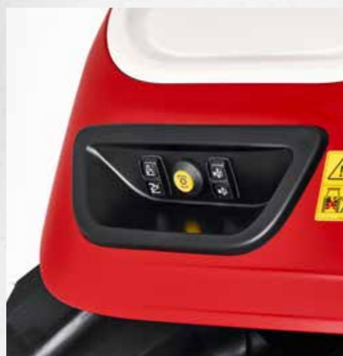
Comando esterno per PTO, sollevatore posteriore e un distributore su entrambi i parafranghi posteriori.
