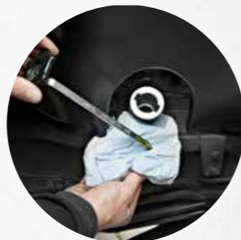
Controllo del livello dell'olio e rabbocco senza sollevare il cofano motore.
