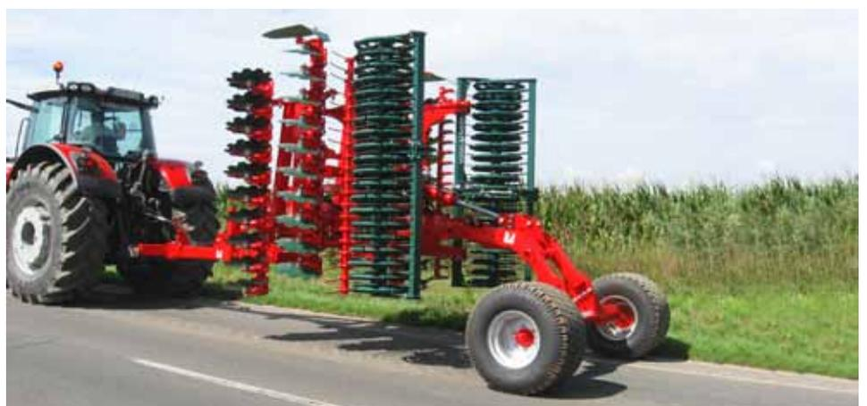
Die TerraDisc<sup>pro</sup> Hydro ist verfügbar mit 4,00, 5,00 sowie 6,00 Metern Arbeitsbreite in hydraulisch klappbarer Rahmenbauweise, optional auch mit **Aufsattel-Fahrwerk** (Details siehe Seite 10).
