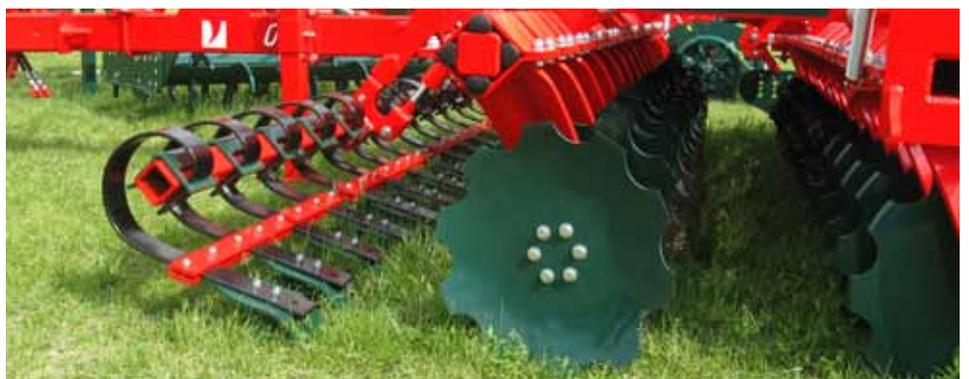
Optional erhältliches **hydraulisch verstellbares Crossboard** für noch bessere Krümelung und Einebnung: geeignet für TerraDisc<sup>pro</sup> TR mit 3,00, 3,50\* sowie 4,00\* m Arbeitsbreite in starrer Rahmenbauweise.
