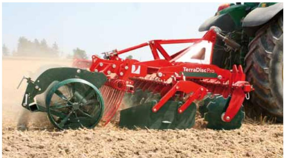
Die TerraDisc<sup>pro</sup> ist verfügbar mit 2,50, 3,00, 3,50\* sowie 4,00\* Metern Arbeitsbreite in starrer Rahmenbauweise
