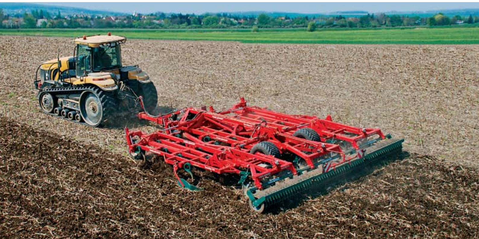
TerraTop 800 S con rodillo de anillos cónicos de caucho y púas de muelle espiral de serie
