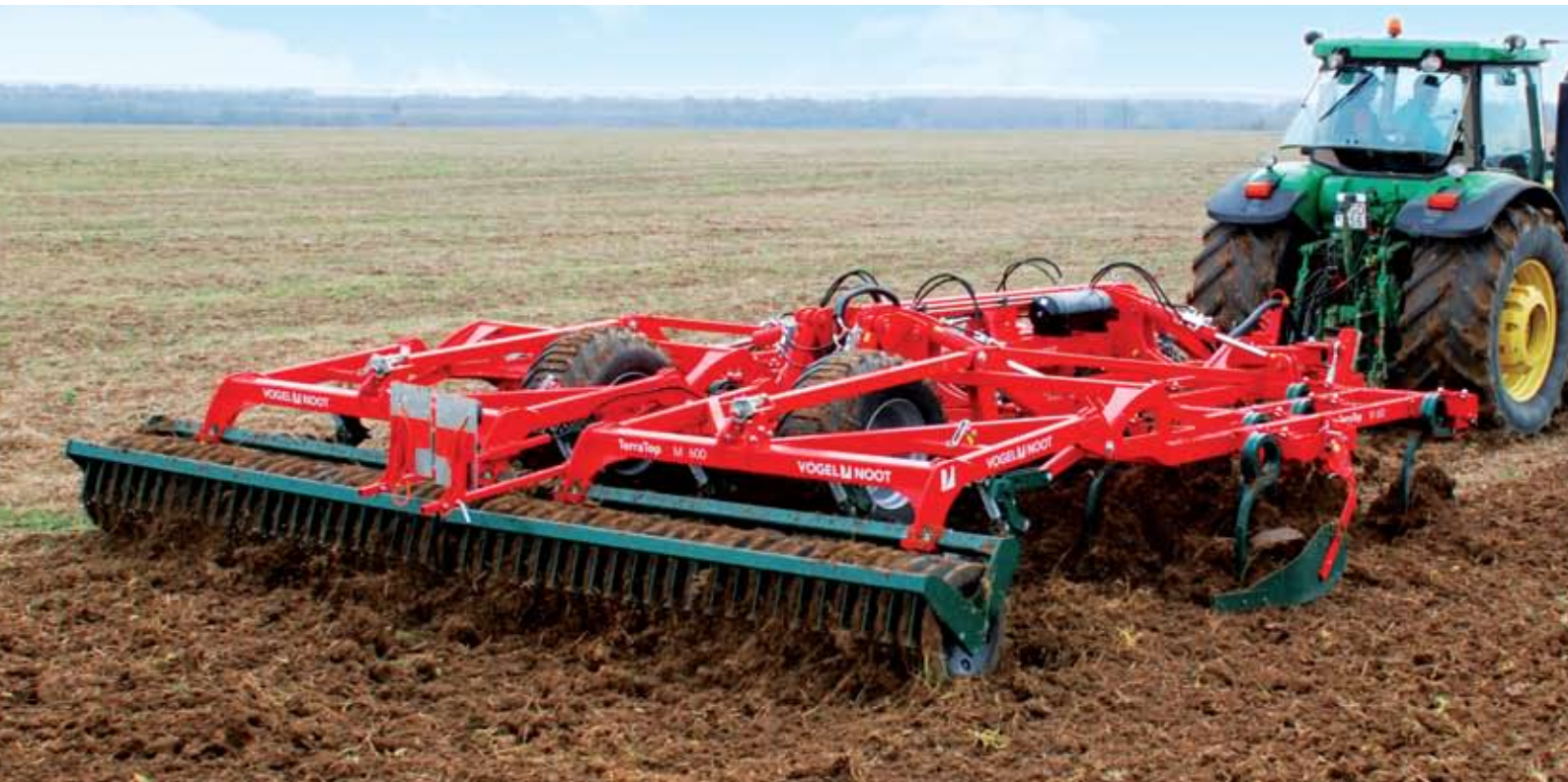
TerraTop M 600 con rodillo de aros cónicos de caucho y púas espiral de serie.
