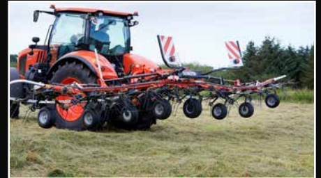
Der TE6576 kann optional mit dem hydraulischen Vorgewendeseit ausgerüstet werden.
