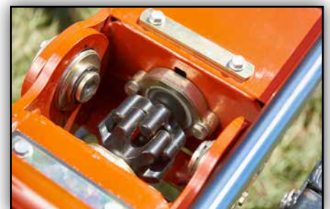
180° Klappung der äußeren Rotoren für den Transport dank der HexaLink Fingerkupplung.
