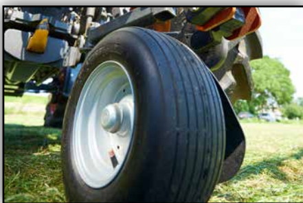
Alle Wender können optional mit einem Stützrad ausgestattet werden. Dies entlastet gerade bei langen Arbeitstagen den Fahrer und sorgt immer für gleichbleibende Arbeitsqualität.
