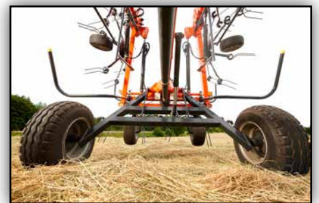
Breite Transportachse für sicheren Straßentransport.
