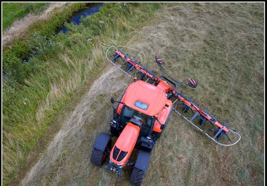
Zentrale Einstellung für das Grenzsetzen aus der Schlepperkabine.
