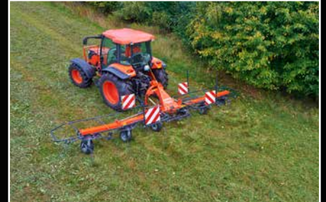
Zentrale Grenzstreueinrichtung ist bei allen Modellen Standard.
