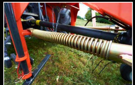
Standard Schwingungsdämpfer am TE6060 sorgen für ein gleichmäßiges Streubild.
