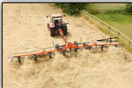
Die drei äußeren Kreisel auf der rechten Seite werden über einen Hydraulikzylinder zum Grenzstreuen verstellt.
