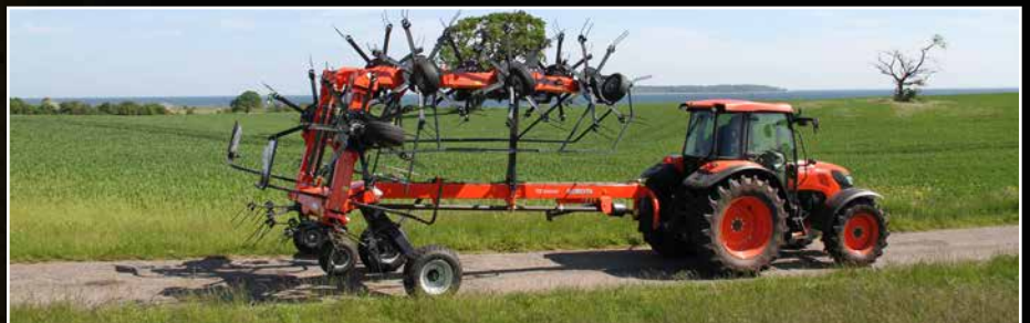
Einfacher Transport dank einer Transporthöhe von 3,35m und einer Transportbreite von 3,00m.
