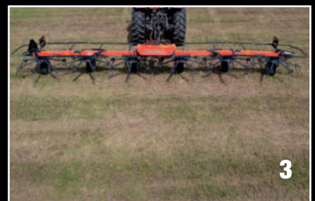
Omzetten van transport- naar werkstand gaat eenvoudig vanuit de cabine.
