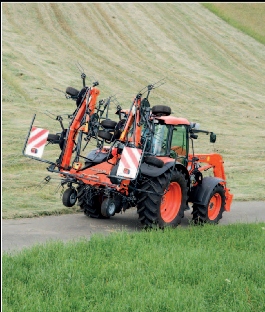
TE8080 klapt in tot een zeer compacte transport positie.
