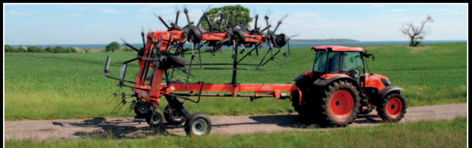
Tijdens transport is de hoogte slechts 3,35 m en maximaal 3,00 m breed.
