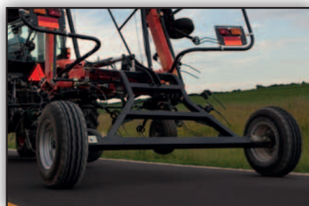
De brede spoorbreedte zorgt voor een perfect spoorvolgning.
