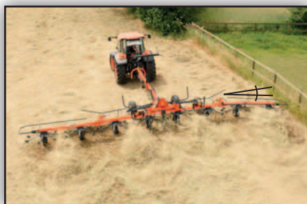
Voor het kantschudden kunnen de buitenste 3 rotoren hydraulisch naar binnen worden gezet.
