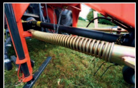
De standaard stabilisatoren TE6060 zorgen voor een gelijkmatige spreiding.
