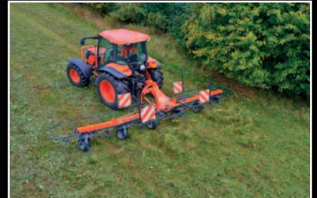
Centrale verstelling voor kantschudden – allemaal te bedienen vanuit de trekker cabine.
