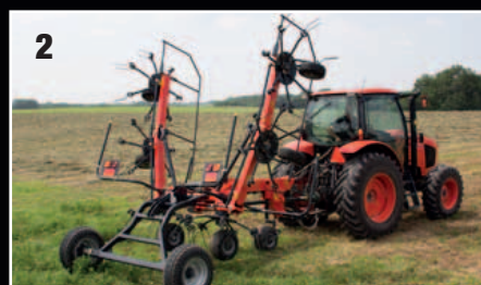
Kubota TE6576C en TE8590C maakt de schudder ideaal voor kleinere trekkers.
