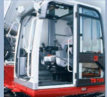
Eine vibrationsgedämpfte Komfortkabine mit getönten Scheiben, großem Volumen und einer serienmäßigen Klimaanlage, bieten dem Bediener einen optimalen Arbeitsplatz.
