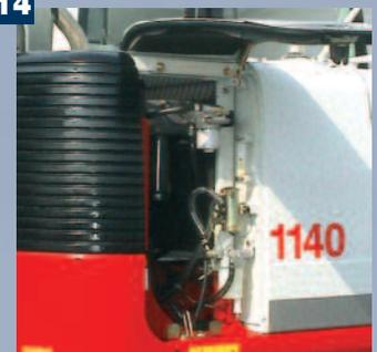
Kurze Inspektionszeiten durch Messstellen am Hydrauliksystem.
