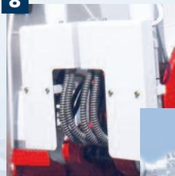
sowie Rohrbruchsicherung und Lasthalteventile am Stielzylinder serienmäßig.
